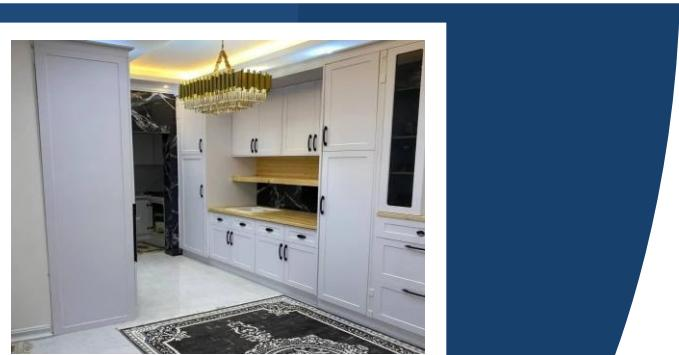
بدنه این سبک از ام دی اف درجه یک سفید صابونی و درب های آن بسته به متریال از ۱۸ میلی متر شروع می شود..
